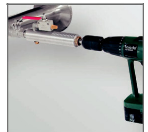
Anbohren unter Druck mit der CS Bohrvorrichtung
